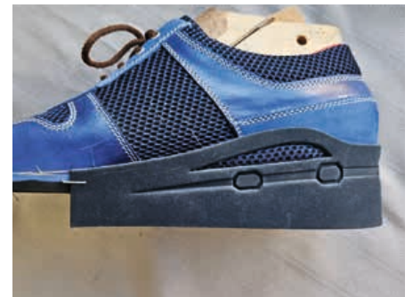
17 Die hintere Verschalung positionieren und anzeichnen.
