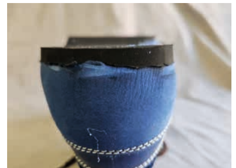
9 Das EVA von der Seite und Unten beschleifen.
