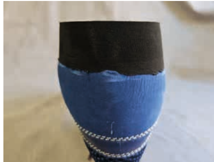
14 Die Sohlenform seitlich beschleifen.
