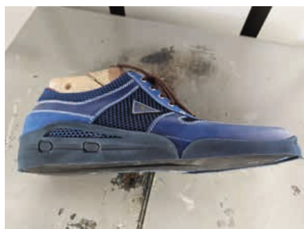
22 Die Verschalungen mit dem Schuh verkleben.
