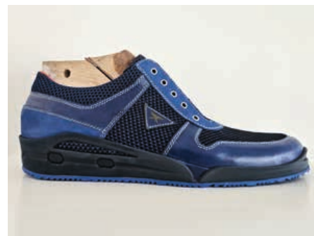
26 Die fertige Schalensohle.
