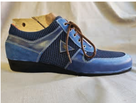
15 Die fertige Aufbausohle.
