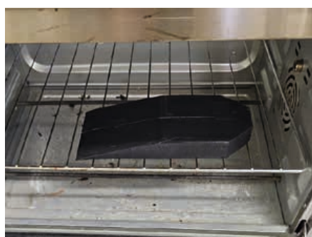
11 Den Aufbaukeil im Ofen bei 130 Grad erwärmen.
