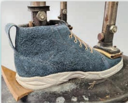
Nach der Ablüftezeit die Schalensohle am gewickelten Schuh positionieren und unter leichtem Druck mit der Sohlenpresse anpressen.
