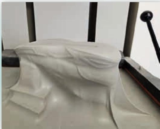
Für das seitliche Anpressen den Schuh in das Vakuumtherm stellen und die Sohle mit der Tiefziehfolie am Oberleder anpressen.
